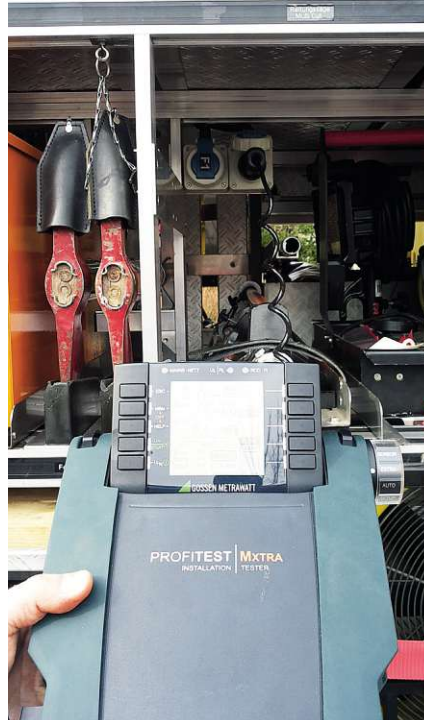
Bild 1: Das Prüfgerät »Profitest MXTRA« eignet sich für Messungen an Stromerzeugungsaggregaten
